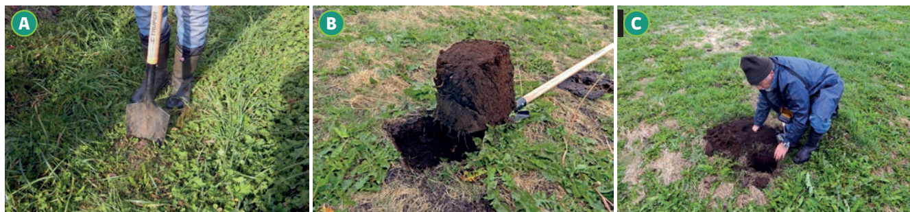
Figura 5. Secuencia de toma de muestra con pala recta y revisión de la muestra en terreno
